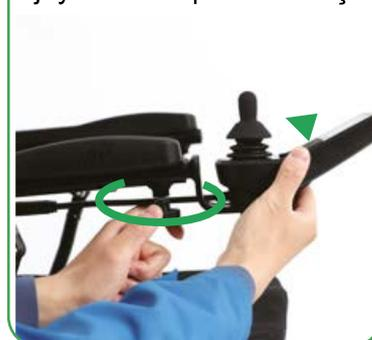
6. Conecte o chicote de fios do controlador ao chicote de fios da CPU. Tome cuidado para alinhar os pinos corretamente conforme a ponta da seta indica, para que eles não fiquem dobrados, quebrados ou danificados.
