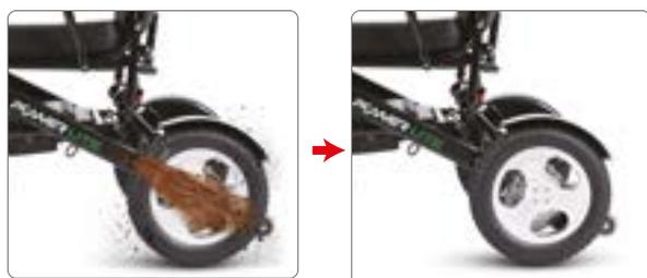
Se a cadeira de rodas motorizada estiver na praia, cascalho ou estrada molhada, se houver areia, lama ou cascalho no pneu, eles devem ser limpos a tempo de evitar que algumas peças enferrujem ou afetem o funcionamento do pneu, além da beleza, conforto e segurança ao utilizar
